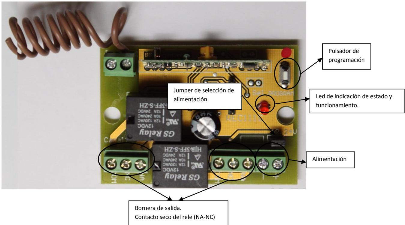
Alimentación: + Conexión de 12 o 24v de corriente alterna o continua.
